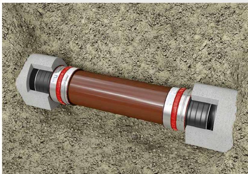
L'adaptateur BI-Funke intérieur/intérieur (DN 250 – 600) propose une solution simple pour les situations dans lesquelles une canalisation en béton existante doit être raccordée à une nouvelle canalisation en béton non conforme aux cotes. Grâce à l'adaptateur BI intérieur/intérieur, il est possible de raccorder les deux canalisations de manière fiable et étanche lorsque l'extrémité du nouveau tube à raccorder n'est pas adaptée au manchon du tube existant.
