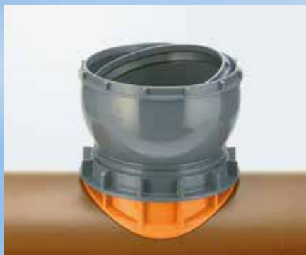
CONNEX-aansluiting DN/OD 160/162 op HS®-rioolbuis, boring 162 ± 1 mm
