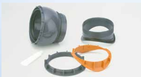
De CONNEX-set bestaat uit het bovenste deel van de aansluiting, onderste deel van de aansluiting, opvulling, wartel, een tube glijmiddel en productinformatie met montagehandleiding.
